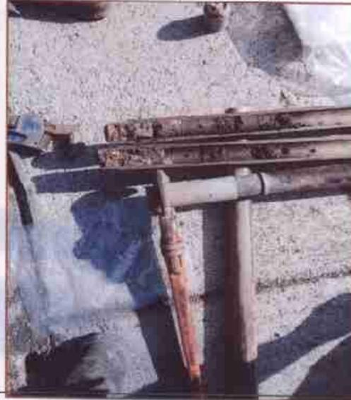
Toma de muestras con el muestreado de tubo partido SPE No. 2
